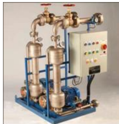
Ilustración 16 - Paquete bomba y separador de agua para lubricación.
