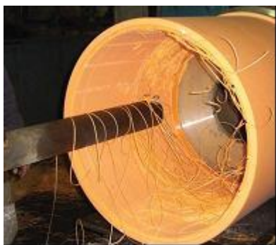
Ilustración 13. Maquinado de bocín para acople con alojamiento.
