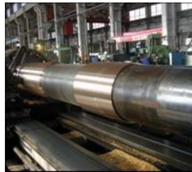
Ilustración 11. Colocación de camisas en eje.
