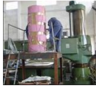
Ilustración 9. Calentamiento de camisa.
