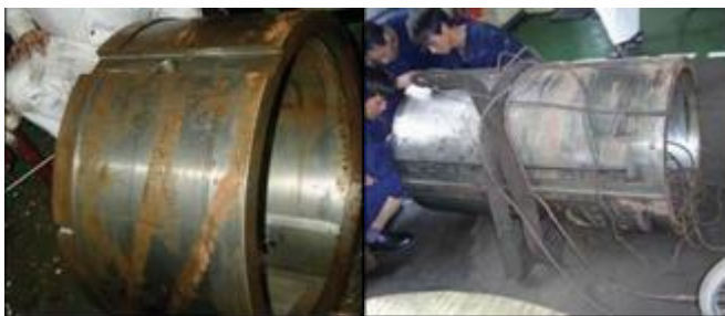
Ilustración 7. Remoción y chequeo de eje y bocín.
