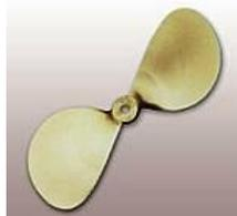
razón de usar más de 3 aspas es la reducción de la vibración. Cada vez que las aspas pasan debajo del casco o el arbotante, causan un cambio de presión que genera un empuje. Si este empuje es muy fuerte puede generar un golpeteo. Muchos golpeteos equivalen a vibración. En conclusión a menor número de aspas la eficiencia aumenta, y a mayor número de aspas el desempeño es más suave y uniforme. Esto debe ser siempre tomado en cuenta cuando se selecciona el Diámetro, Paso, Área y forma de las Aspas.
