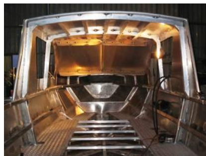
EM3 con refuerzos longitudinales
