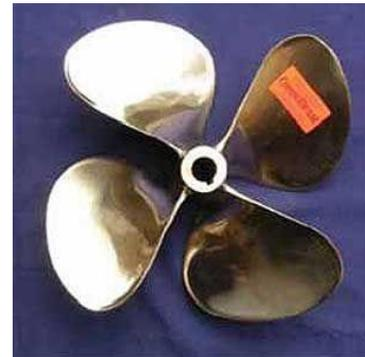
La norma ISO 484/2-1981 establece las tolerancias para la fabricación de hélices en todas sus dimensiones geométricas. Y las divide en las siguientes clases: S, I, II y III de las cuales las más precisas son las clase ISO S. Esta norma contempla todas las dimensiones de 1 hélice como son: Paso, Diámetro, Anchos, Lanzamientos, Espesores y separación entre aspas. La norma pide que sean revisadas las dimensiones de ciertos radios, esto de acuerdo al tipo de hélice que se va a fabricar
