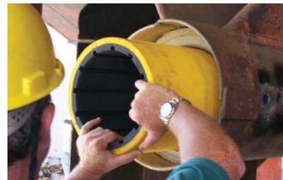
**2. PARA BOMBAS:** estos bocines pueden ser usados para bombas verticales, en los casos de existir problemas de cavitación, en las estaciones de energía nuclear protegiendo a los componentes de la abrasión.
