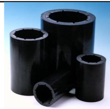
**BOCINES DE ELASTÓMEROS TIPO XL:** Es el grado mas corriente de bocines *Thordon* en aplicaciones en bombas. **El grado XL proporciona un buen equilibrio entre larga vida, bajo coeficiente de fricción en seco, una razonable resistencia a la abrasión y bajo costo.** Una capacidad de trabajar en seco limitada 10 a 15 segundos, y su rendimiento óptimo se alcanza operando en fluidos relativamente limpios y no abrasivos.
